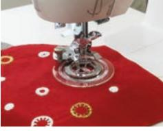
Remarque: si vous utilisez une aiguille double, réglez la machine pour l'aiguille double ou ajustez la largeur de point sur 2 ou moins. Un entoilage peut s'avérer nécessaire pour empêcher le tissu de froncer.
