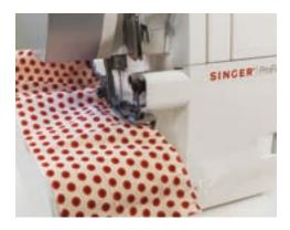
Remarque: une plus grande longueur de point, une tension plus élevée et l'augmentation du réglage de l'entraînement produiront des fronces plus denses.
