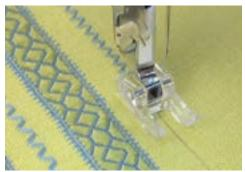
Remarque: pour aligner plusieurs rangées de points, tracez des lignes de guidage à l'aide d'un marqueur. Placez un entoilage sous le tissu pour éviter les faux-
